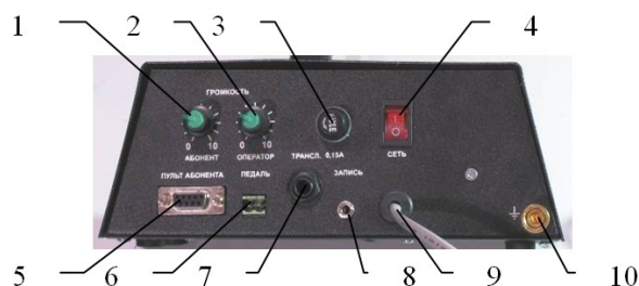
Рисунок 1.2 – Задняя стенка консоли оператора “Мост-дуплекс”
