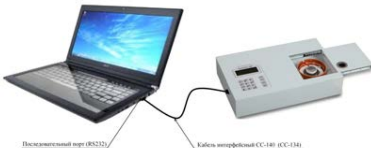
Рисунок 19 – Схема подключения Установки к ПК
