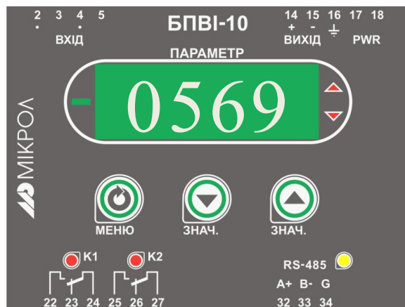
Рисунок А.1 – Внешний вид передней панели преобразователя БПВІ-10
