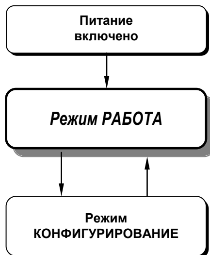
Рисунок 4.6.1 – Диаграмма режимов работы и настройки преобразователя БПВІ-10
