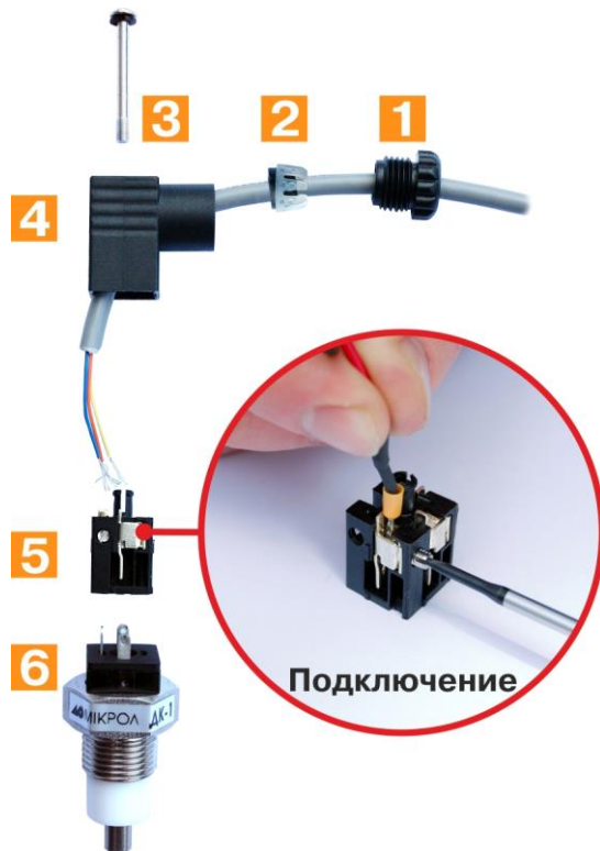
Рисунок 2 – Подключение проводов к полюсам коннектора держателя ДК-1
