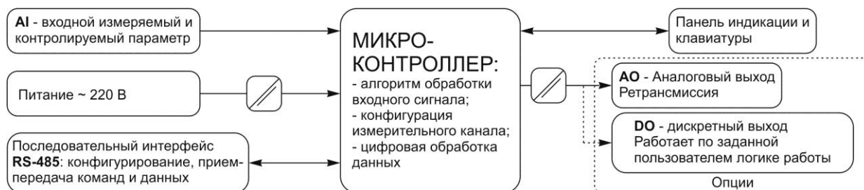
Рисунок 3.2 - Структурная схема вольтметра ИПМ-1
