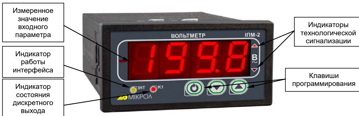
Рисунок 3.1 - Внешний вид вольтметра ИПМ-2
