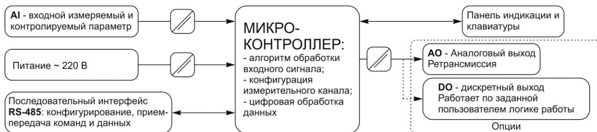
Рисунок 3.2 - Структурная схема вольтметра ИПМ-2
