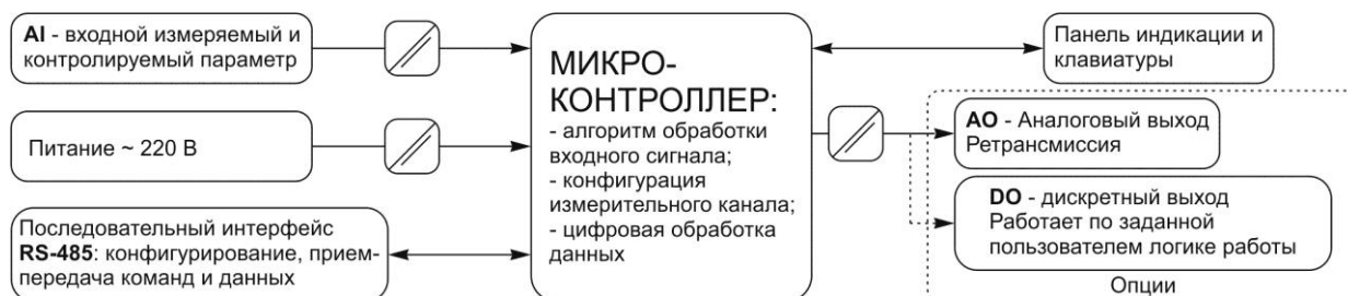
Рисунок 3.2 - Структурная схема амперметра ИПМ-3
