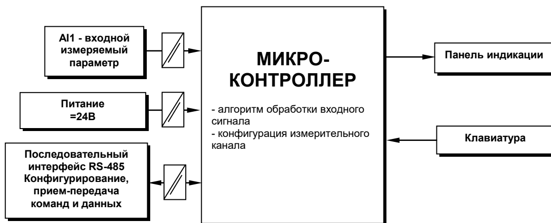
Рисунок 5.3 - Структурная схема индикаторов ИТМ-1-10 и ИТМ-1-14
