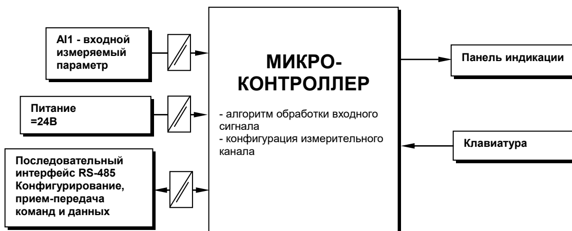
Рисунок 5.3 - Структурная схема индикаторов ИТМ-1-01-31 и ИТМ-1-01-41
