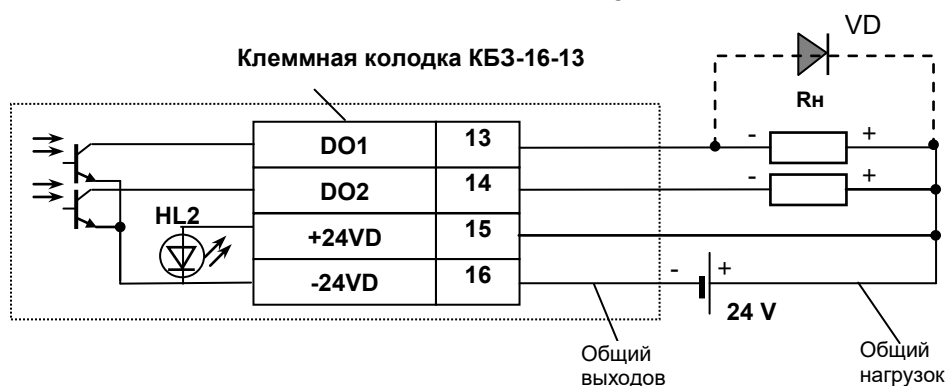
Рисунок Б.14 - Подключение дискретных нагрузок с помощью КБЗ-16-13
