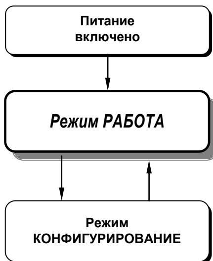
Рисунок 6.1 - Диаграмма режимов работы, защиты и настроек индикатора ИТМ-10
