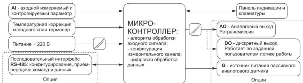
Рисунок 3.2 - Структурная схема индикатора ИТМ-100
