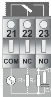
Рисунок Б.2 – Схема подключения индуктивной нагрузки к механическому реле
