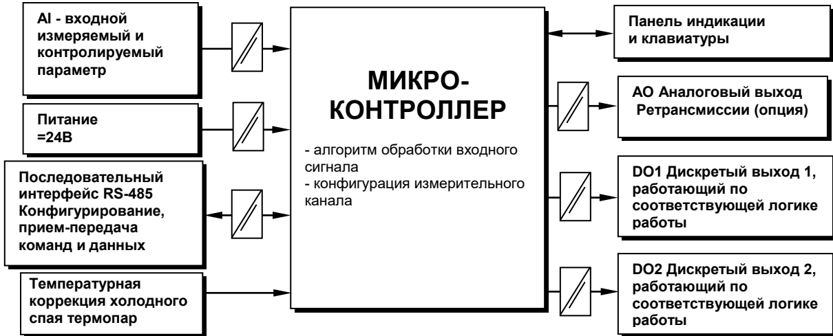
Рисунок 5.2 - Структурная схема индикаторов ИТМ-11, ИТМ-11В
