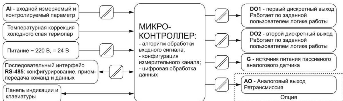
Рисунок 3.2 - Структурная схема индикатора ИТМ-110Н
