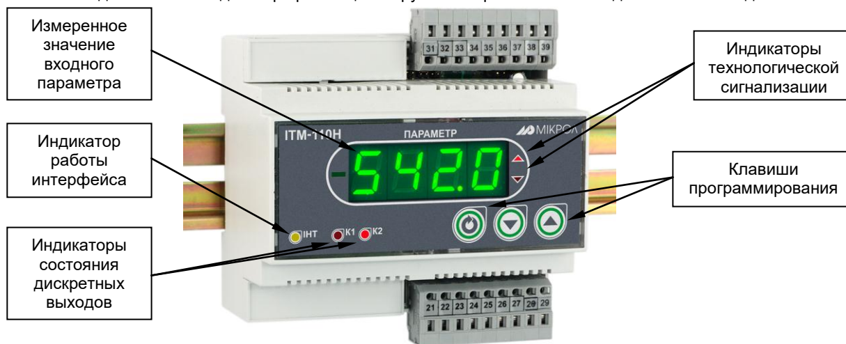
Рисунок 3.1 - Внешний вид индикатора ИТМ-110Н
