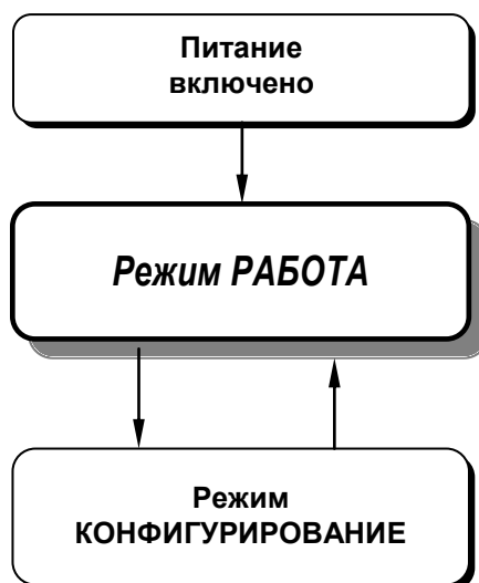
Рисунок 4.1 - Диаграмма режимов работы и настройки индикатора ИТМ-112
