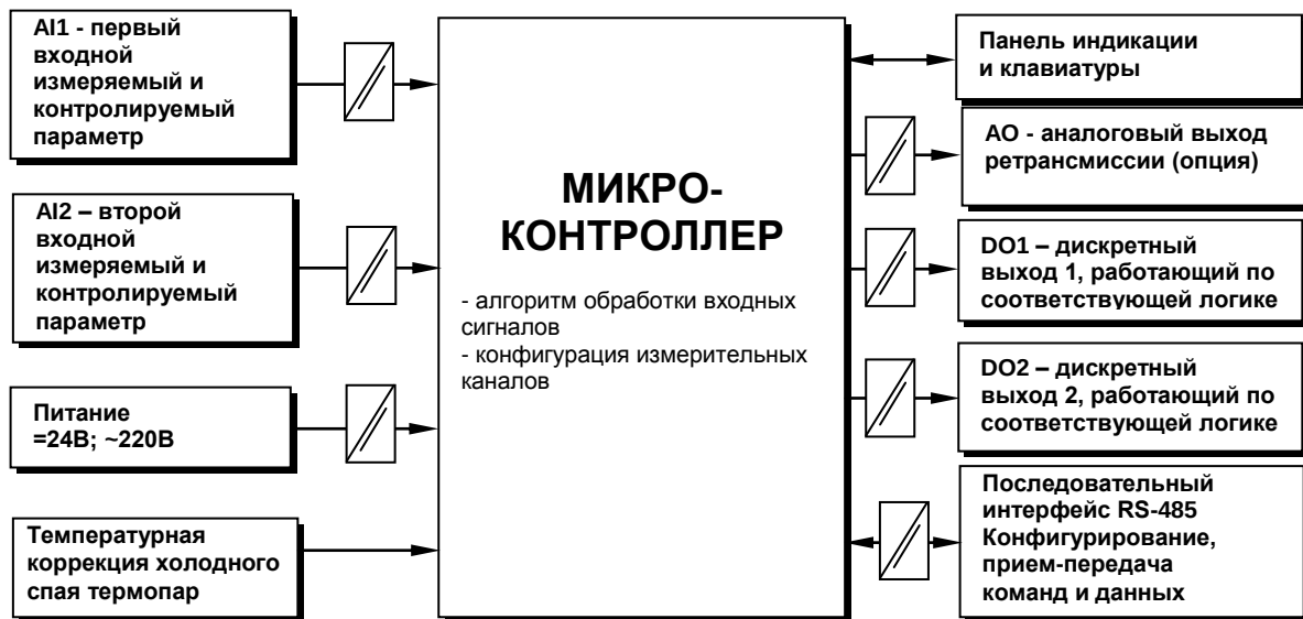
Рисунок 3.2 - Структурная схема индикатора ИТМ-112
