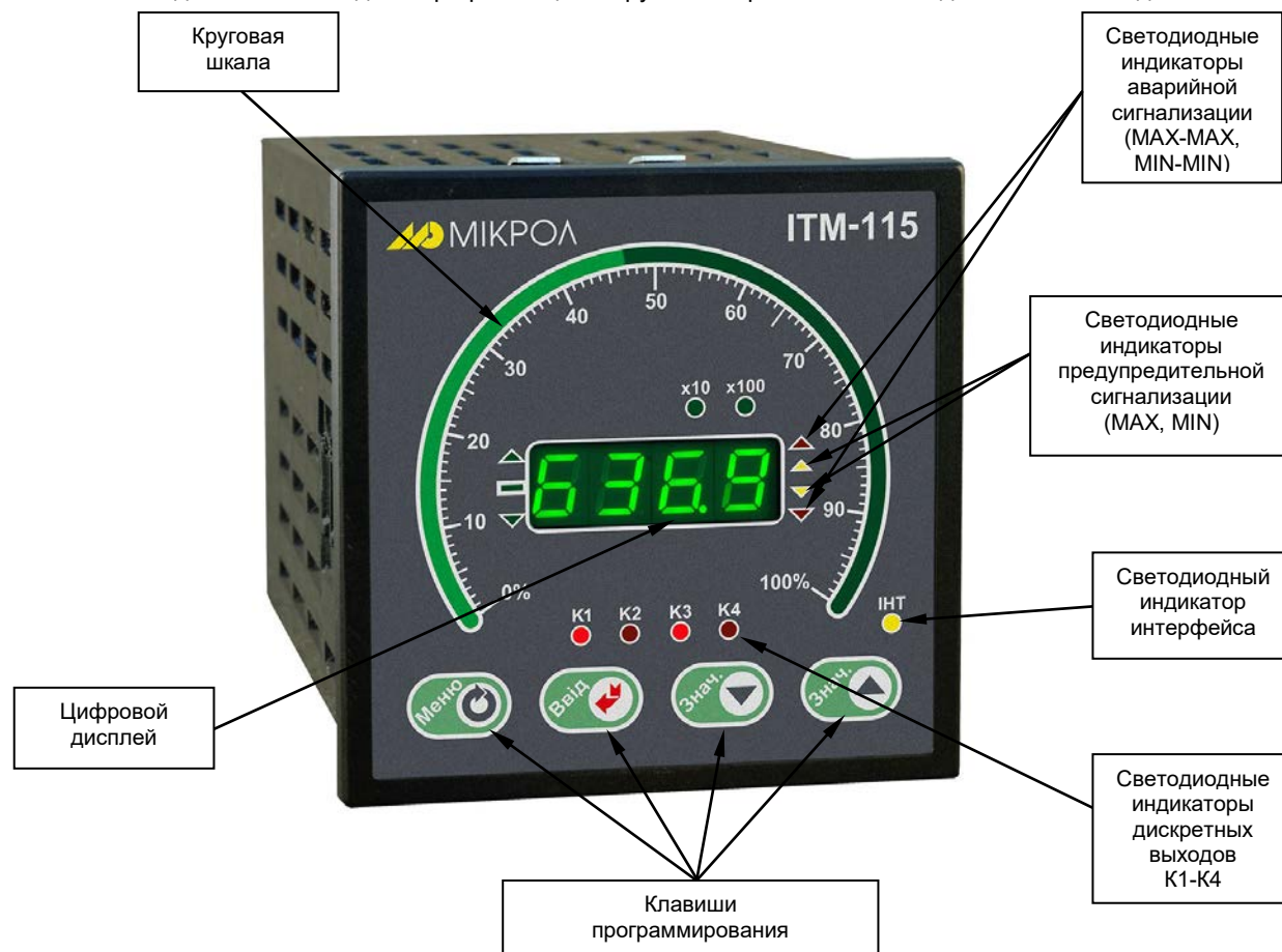
Рисунок 3.1 - Внешний вид передней панели индикатора ИТМ-115
