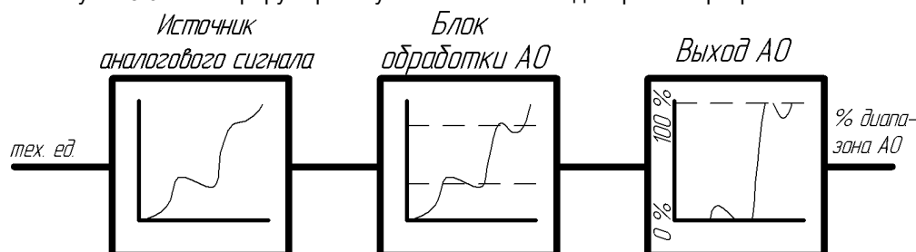
Рисунок 3.6 – Работа блока аналогового вывода в режиме ретрансмиссии
