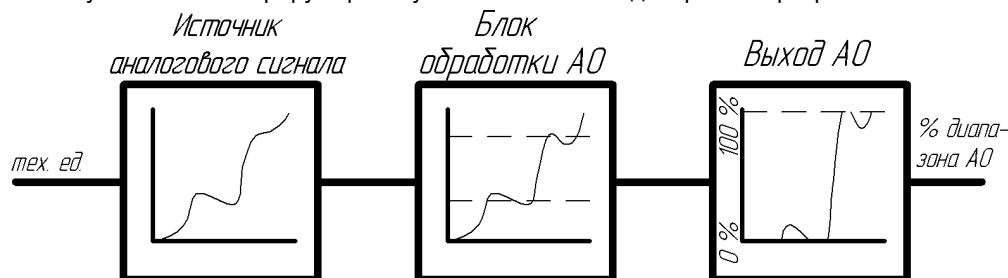
Рисунок 3.6 – Работа блока аналогового вывода в режиме ретрансмиссии
