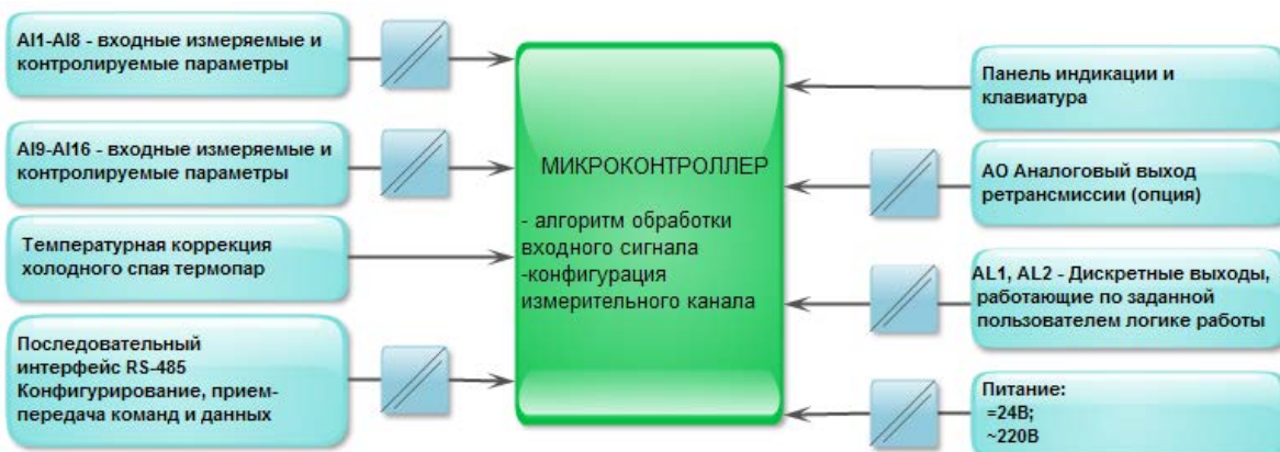
Рисунок 3.2 - Структурная схема индикатора ИТМ-16
