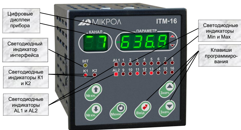
Рисунок 3.1 - Внешний вид передней панели индикатора ИТМ-16.
