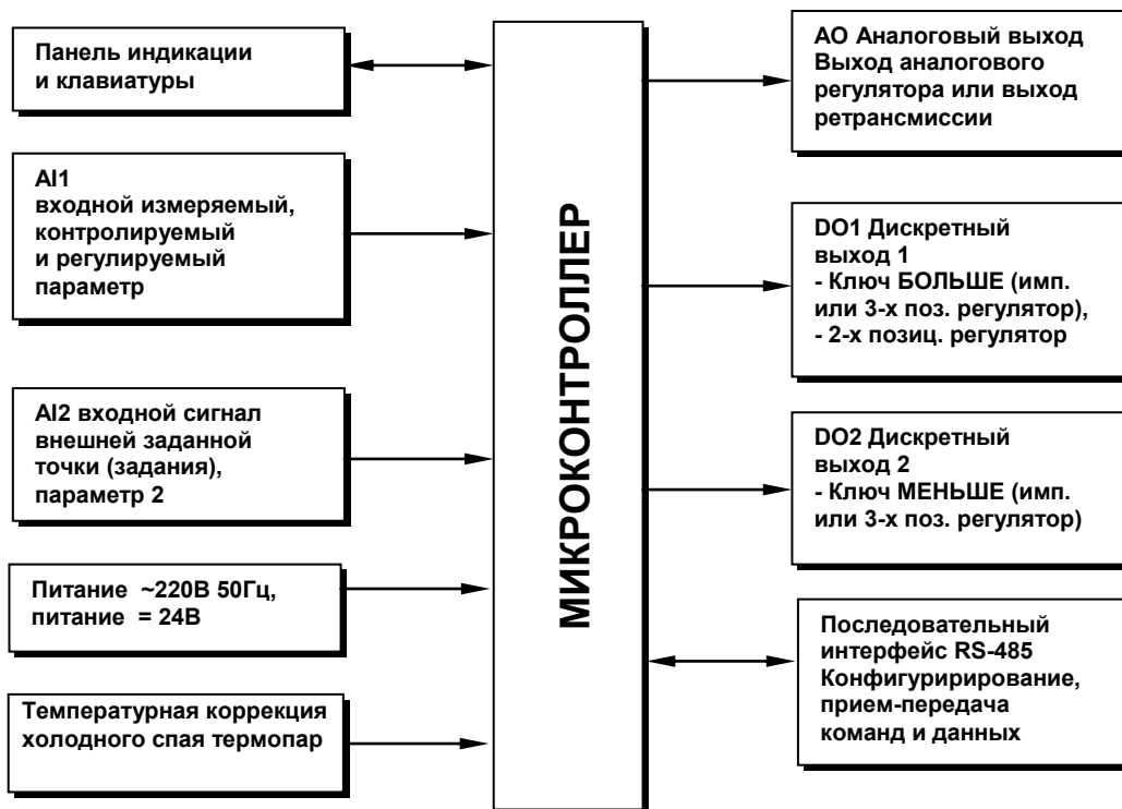
Рисунок 3.2 – Структурная схема регулятора МИК-112
