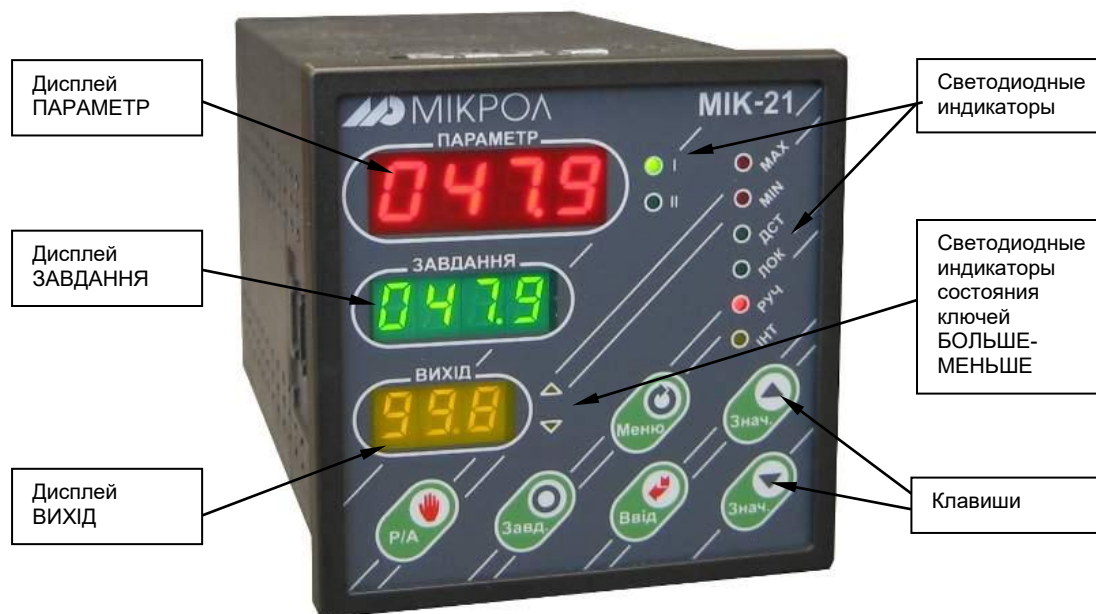
Рисунок 5.1 - Внешний вид передней панели регулятора МИК-21-05
