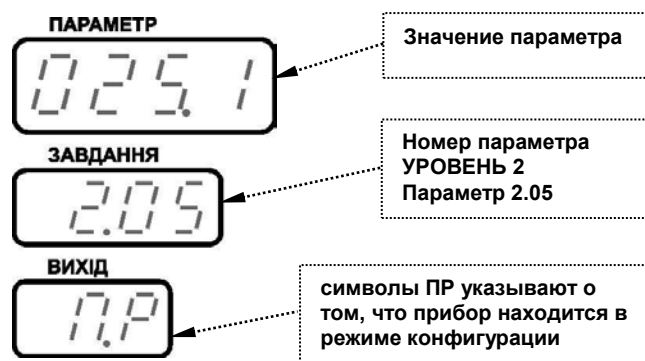
Рисунок 6.4 - Индикация значения параметров конфигурации и их номеров.
