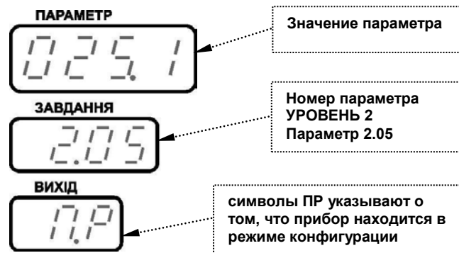
Рисунок 6.3 - Индикация значения параметров конфигурации и их номеров
