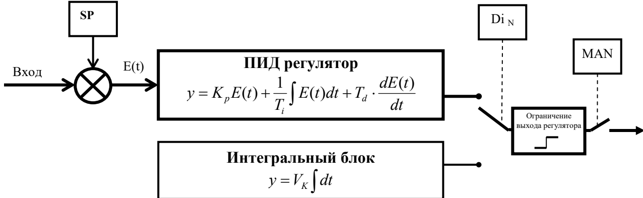
Рисунок 5.4 - Структурная схема регулятора с коррекцией по дискретному входу.
