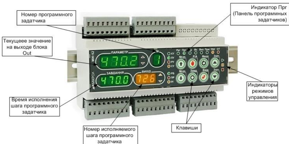
Рисунок 4.5 - Лицевая панель в режиме оперативного управления программным задатчиком
