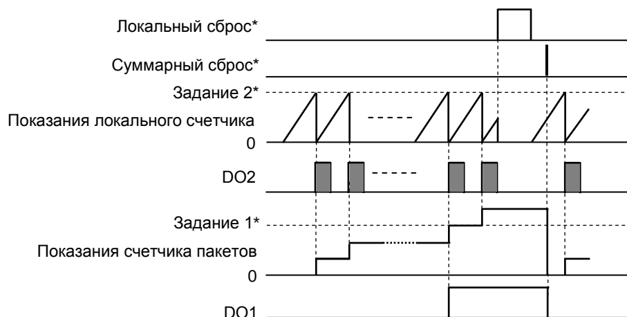
Рисунок 5.4 Диаграмма работы счетчика пакетов.
