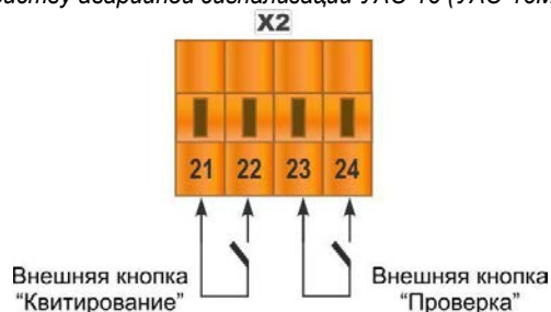
Рисунок А.3 - Подключение внешних кнопок сигналов «Проверка» и «Квитирование» к устройству аварийной сигнализации YAC-16(YAC-16MI)
