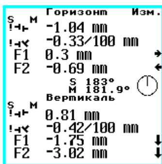
Рисунок 26 - Результаты расчетов а) в режиме реального времени; б) замороженные
