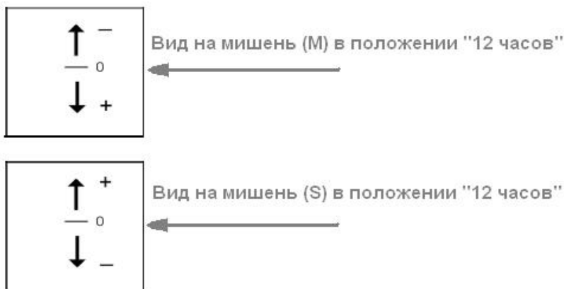
Рисунок 9 - Знаки при вводе значений расцентровки
