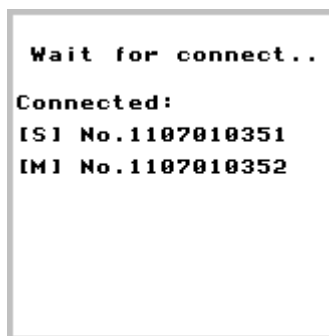
Рисунок 19 - Блок электронный в режиме ожидания подключения измерительных блоков
