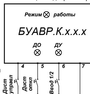
Рис.6 Пример схемы ручного управления АВР с использованием входов дискретного управления БУАВР
