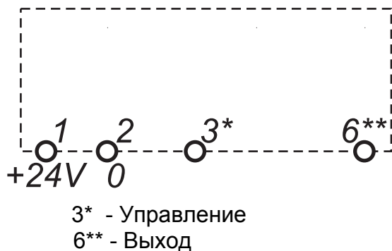
Рисунок 3 - Схема подключения реле ВЛ-63
