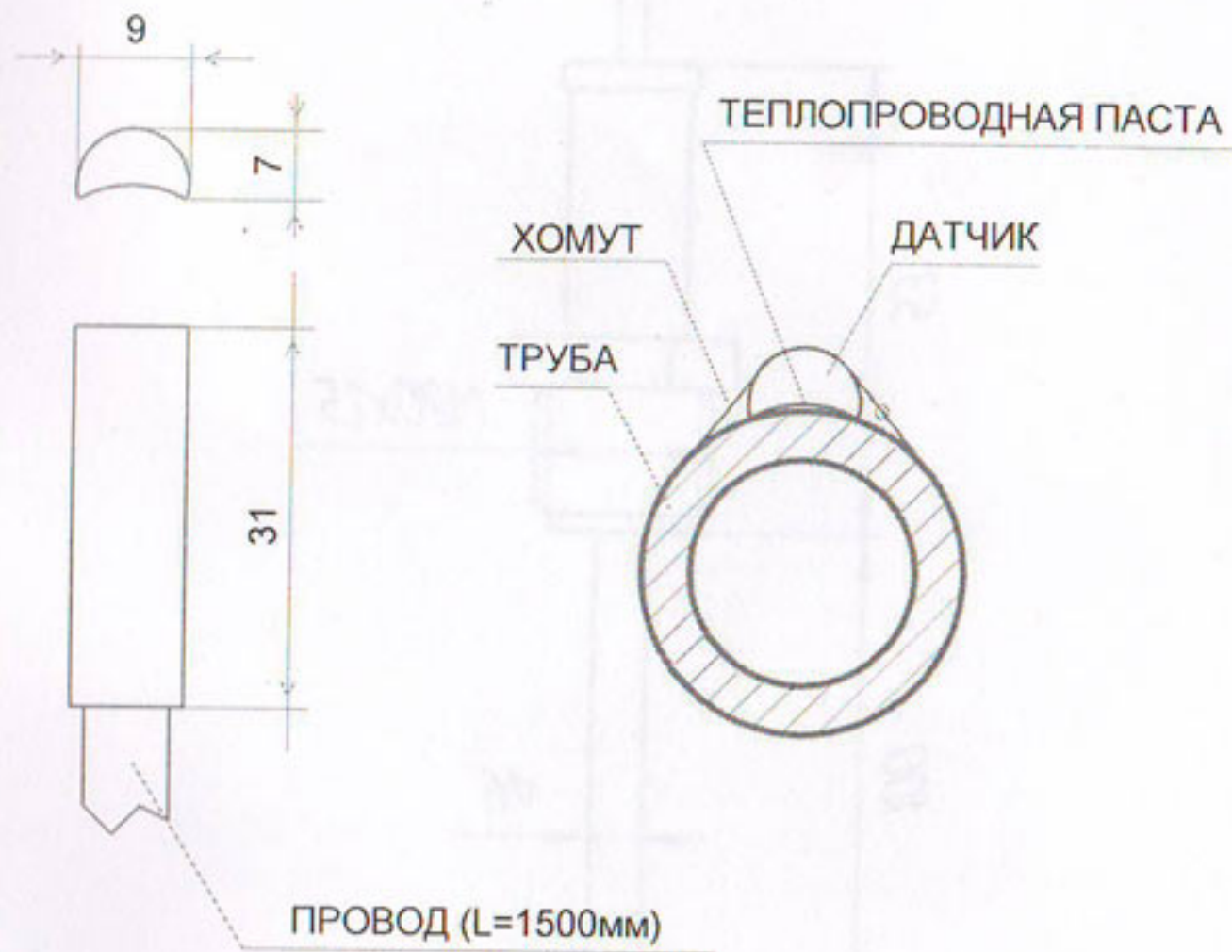
Рисунок 6 - Конструктивные особенности и габаритно-присоединительные размеры датчиков СТв-02, СТв-03
