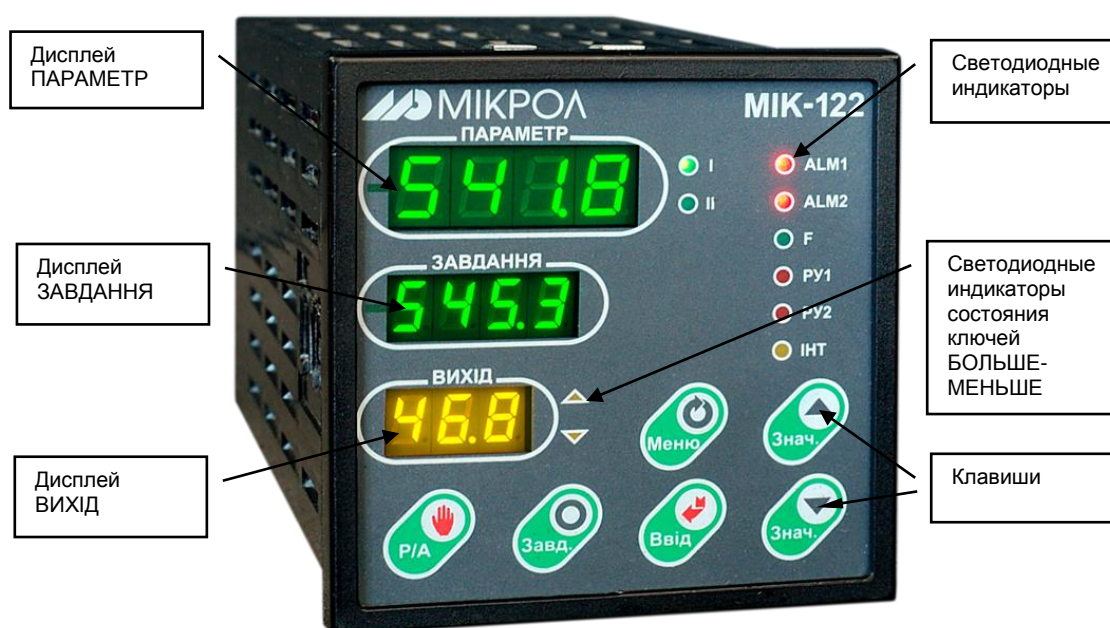
Рисунок 3.1 - Внешний вид передней панели регулятора МИК-122
