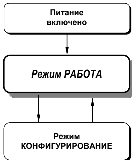
Рисунок 4.6.1 – Диаграмма режимов работы и настройки преобразователя ПНС-11
