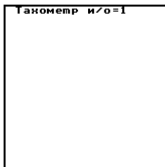
Рисунок 4.6 - Отображение на индикаторе БЭ режима измерений частоты вращения
