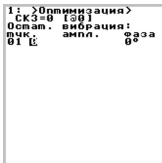
Рисунок 5.12 – Пример отображения на индикаторе результатов расчета остаточной вибрации.
