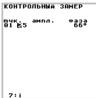
Рисунок 5.13– Пример отображения на индикаторе результатов измерения в режиме «КОНТРОЛЬНЫЙ ЗАМЕР».
