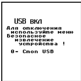
Рисунок 5.36 – Отображение на индикаторе режима передачи данных на ПК.
