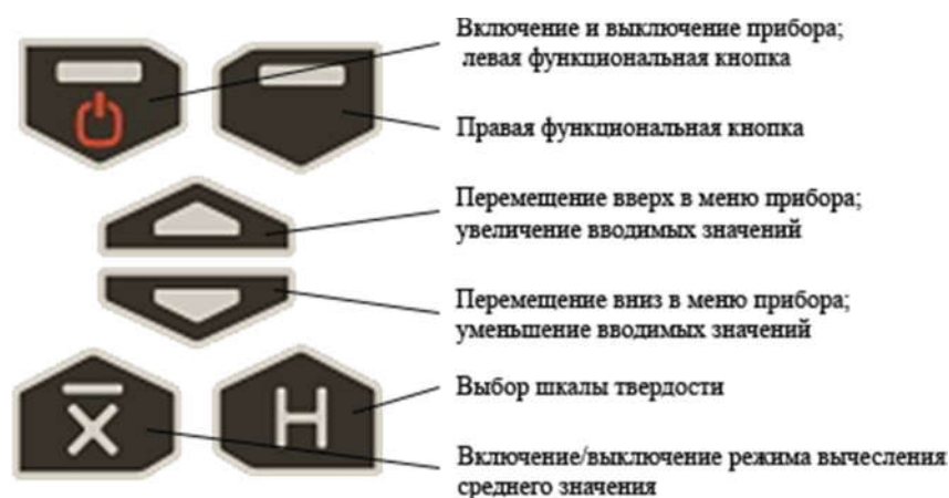
Рисунок 1.3 – Кнопки управления и их функциональное назначение
