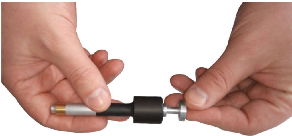
Рисунок 2.7 – Взвод пружины преобразователя
