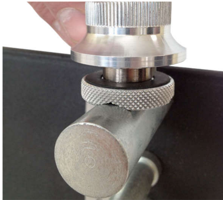
Рисунок 1.5 – Измерение твердости на цилиндрических поверхностях
